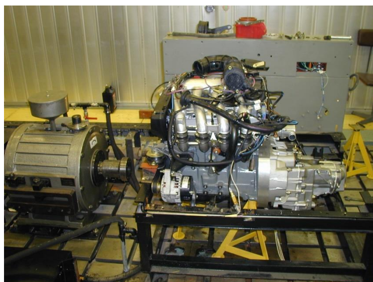
Рис. 2. Установка СГУ на двигатель внутреннего сгорания
