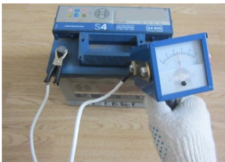
Рис. 3. Измерение заряженности аккумуляторной батареи под нагрузкой
