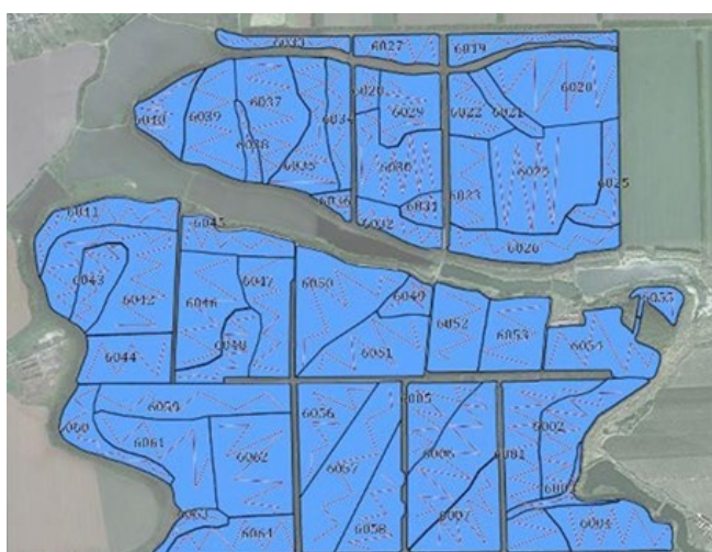
Рисунок 2 - Задание для зонального отбора с прорисовкой маршрутов и номеров почвенных образцов с привязкой к координатам
